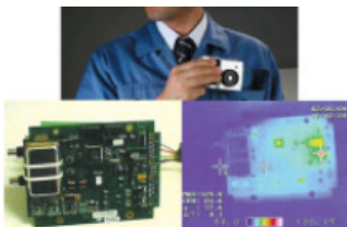
8 ábra. MikroShot hőkamera (-20...+350 °C; 1 GB SD; 160x120 felbontás)
