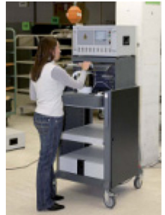
9. ábra. Mérőszekrény mobil kivitelben villamos biztonságtechnikai ellenőrzéshez
