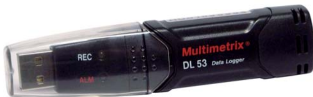
1. ábra. DL53 USB-s miniatúrdatgyűjtő (2x16000 db °C és RH% adat)
