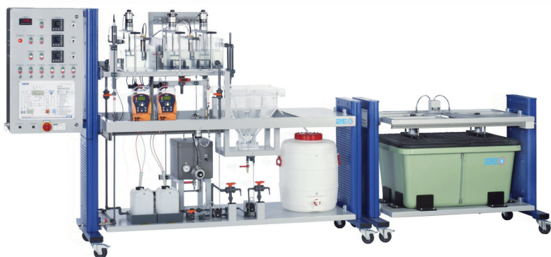
CE 705 működő oktató modul – aktivált szennyvíziszap kezelés
